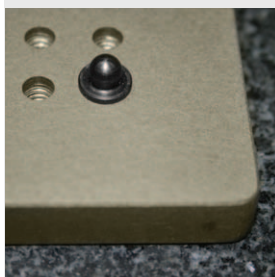
Базирующий шарик для переустановки плит на системе Equator
